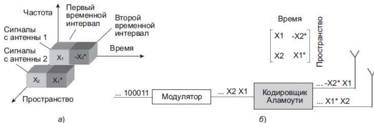
Рис. 21.12. Алгоритм Аламоути: а) блоки данных, разделенные во времени и пространстве; б) излучение пары символов
